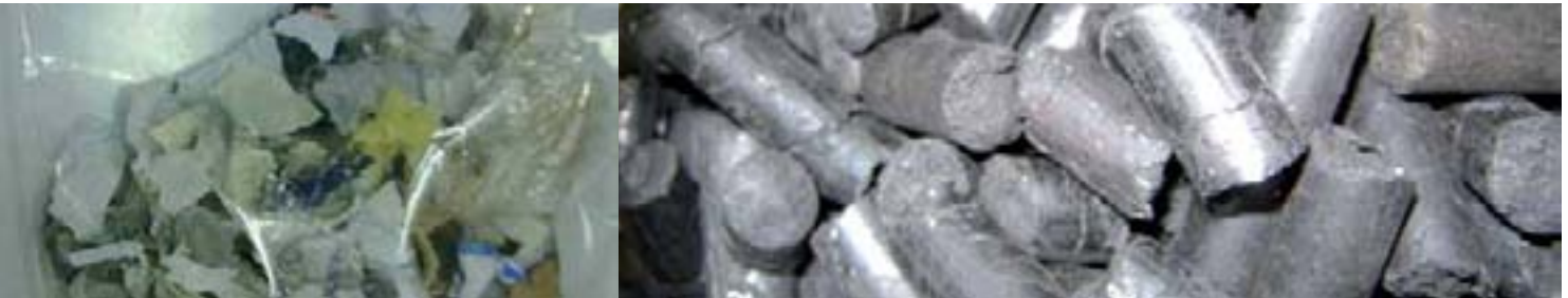
Fabricación de combustible a partir de residuos: pruebas de briquetado y pelletización de Combustible Sólido Recuperado y coque de petróleo. Production of quality fuel from waste: briquetting and pelletizing tests of Solid Recovered Fuel and petroleum coke.
